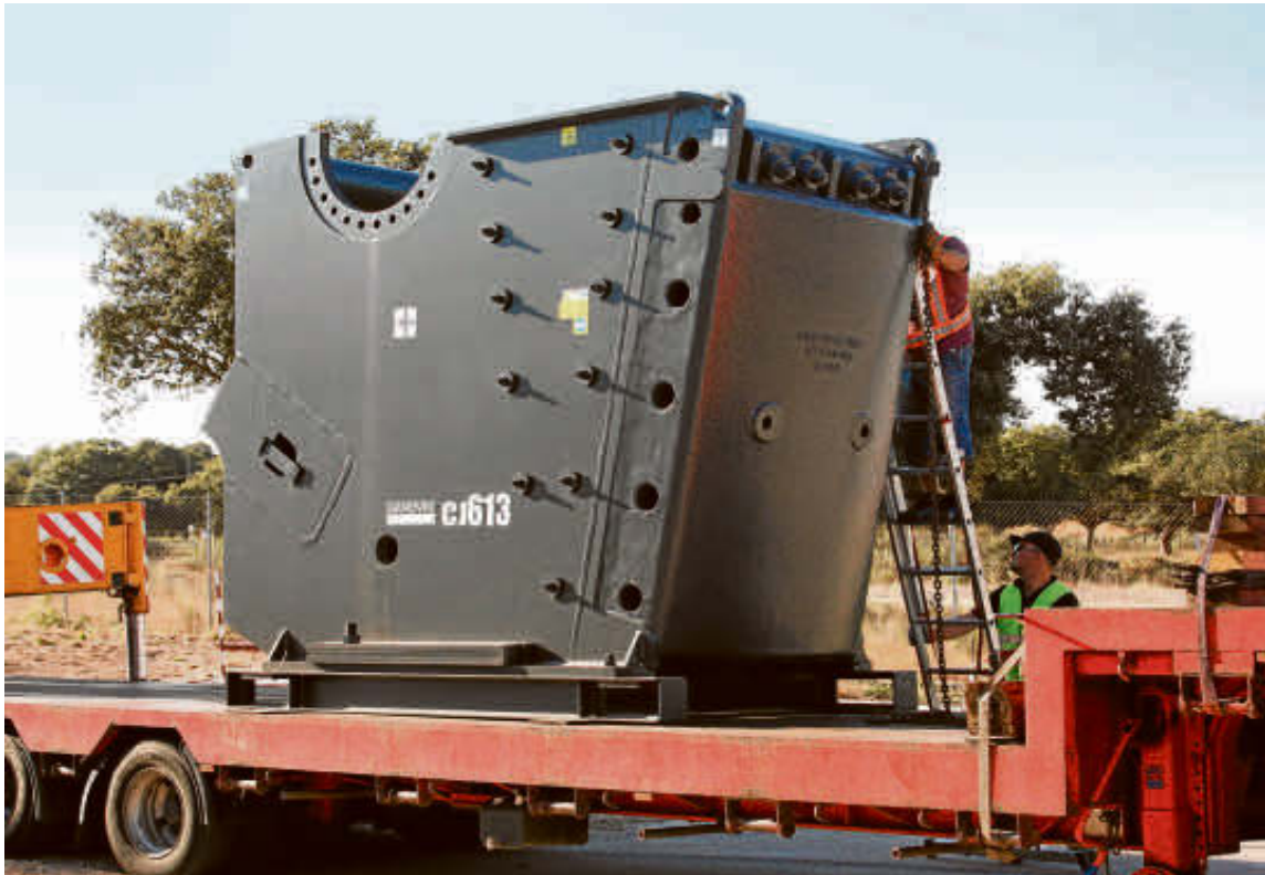
Trituradora primaria incorporada la pasada semana para iniciar la construcción de la explotación minera. | CASAMAR
